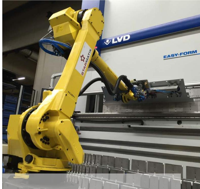
Die Umsetzung der Kundenforderung nach hochkomplexen Bauteilen erfordert in der Blechbearbeitung äußerst flexibel einsetzbare Biegesysteme. Mit unseren Biegerobotern kommen wir diesen Forderungen auch bei sehr anspruchsvollen Werkstücken in großer Stückzahl nach. Die Produktivität wird durch automatisierte Be- und Entladestationen gesteigert.
